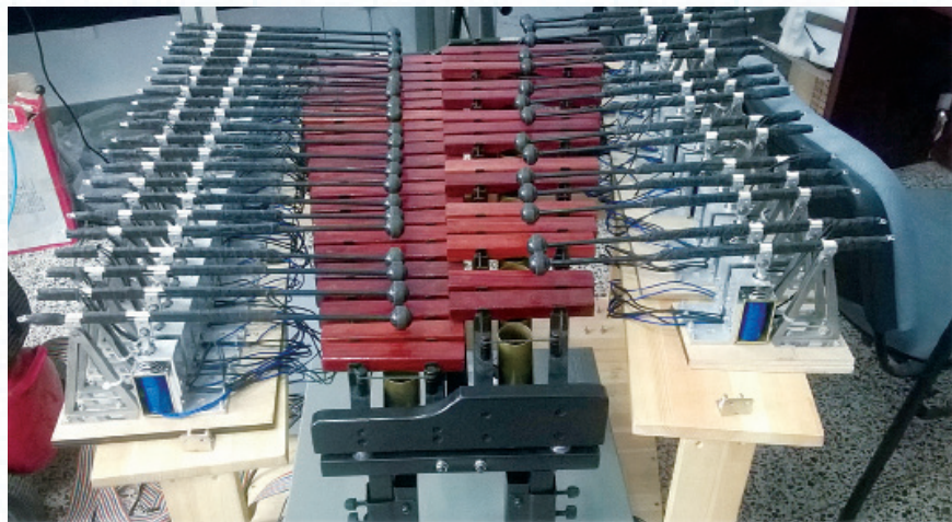
力1班的SRT训练项目成果之一：依靠电子技术实现自动演奏的水琴
