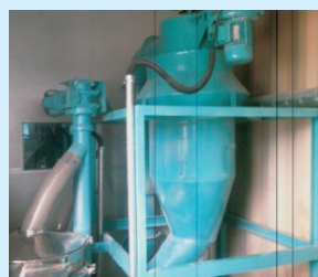
废电路板处理的风选系统
