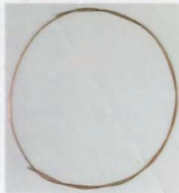
附图2 镀铜焊丝表面局部腐蚀形貌
