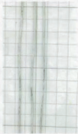
附图1 普通碳素钢表面大气腐蚀形貌
