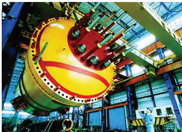
10兆瓦高温气冷实验堆关键设备压力壳
