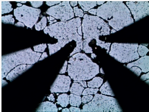
使用微探针平台测量 CCTO 样品的微结构特性 ( 探针部分局部放大 )
