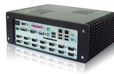
高速芯片组，搭配板载Intel N270处理器；在存储方面，具有SATA、CF卡多种存储手段；显示方面提供1个标准的DB15 VGA接口和1个DB26的LVDS接口，显示终端的多样性为客户提供更多的可选择性；在I/O方面，此平台提供了丰富的接口；具有强大的数据处理能力，且兼具功耗低，接口丰富，整合性能强等优势。除可应用于自助售票系统外，还可做为自动检票系统、交通信号控制集成商的首选嵌入式方案。该产品具有无风扇设计、超低噪音、超低功耗、多串口扩展等特性。
